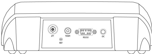
Para el electrodo ST310 debe conectar el enchufe BNC y Cinch. Para el electrodo de pH 2 en 1 (p. ej. ST210) solo necesita conectar BNC.
