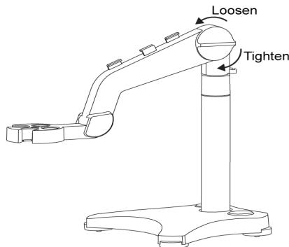
Después de ajustar hasta cierto punto el mando de tensión, puede mover hacia arriba y hacia abajo la parte superior del brazo directamente. Al colocar el electrodo del pH en el brazo y realizar la calibración o medición, se puede colocar el frasco de almacenamiento del electrodo de pH en el hueco de la base.
