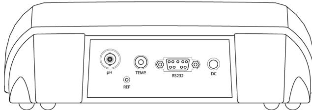
Pour le ST310, l'électrode doit être connectée aux supports BNC et Cinch. Pour l'électrode de pH 2 en 1 (par exemple, ST210), seule la connexion BNC est nécessaire.
