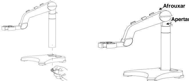
Após a ajustar o botão de tensão em certa medida, você poderá levantar e abaixar diretamente o braço. Quando colocamos um eletrodo de pH no braço e executarmos calibração ou medição, podemos colocar o frasco de armazenamento do eletrodo de pH no orifício da base.
